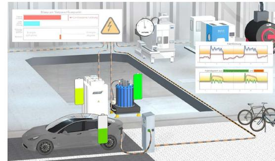
Bild 1: Spitzenlastkompensation durch den Einsatz des hybriden Energiespeichers
