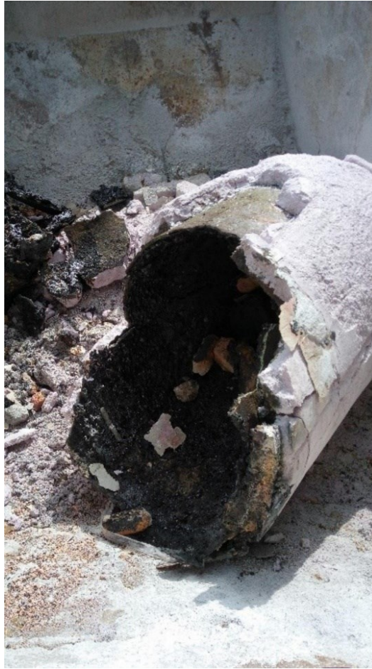
Abbildung 7: Ofenausbruch nach Metallschmelze im Tiegelofen (Quelle: Up-Preneurs)
