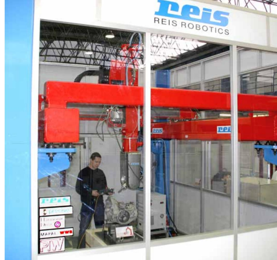
Roboterzelle am PTW zur Gussnachbearbeitung
