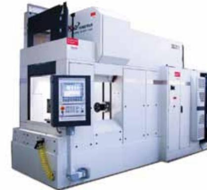
Die Ex-Cell-O XS211 wird als Reihenmaschine in der Zerspanung des Antriebsstrangs eingesetzt. An der Maschine finden vorwiegend Untersuchungen zur Energieeffizienz von Werkzeugmaschinen im Rahmen eines BMWi-geförderten Projekts statt.
