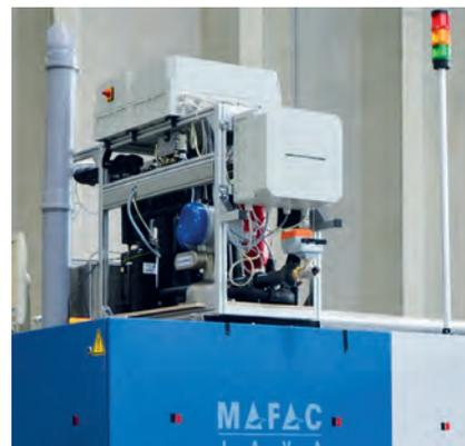
13 Modell und Aufbau des Wärmepumpen-Moduls
