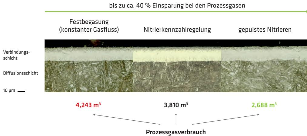
15 In allen drei Varianten haben sich gleiche Schichtstärken der Verbindungsschicht eingestellt: links bei konstanter Begasung, mittig bei Nitrierkennzahlregelung und rechts bei gepulstem Nitrieren.
