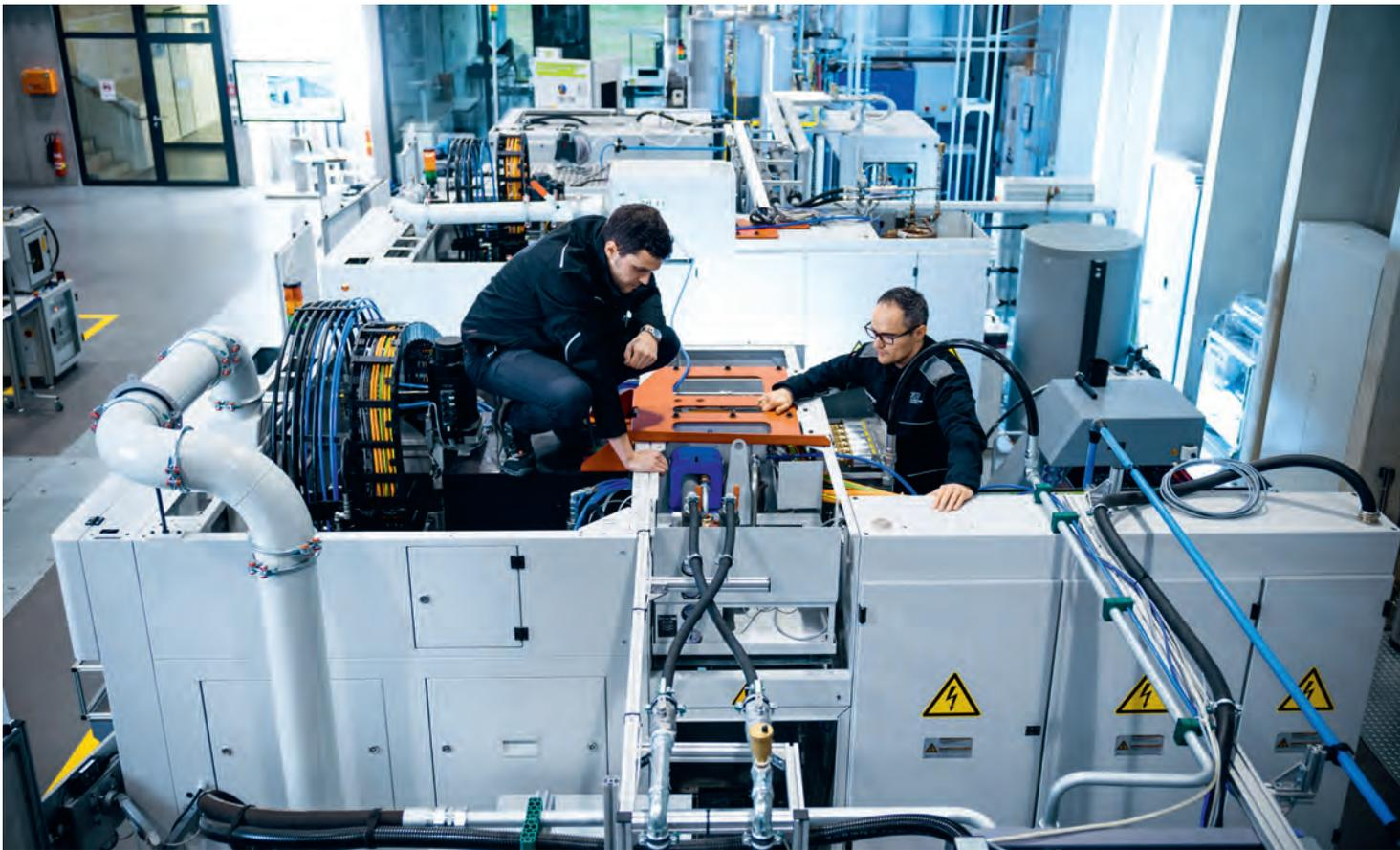
gleichen Motorspindeln mit unterschiedlichem elektrischen Antrieb: Synchronreluktanzantrieb (SynRM) im Vergleich zum Asynchronantrieb (ASM). Dazu wurden die Antriebe auf dem Prüfstand untersucht, um die Verluste und den Wirkungsgrad zu bestimmen sowie das thermische Verhalten zu analysieren (Abb. 06).
