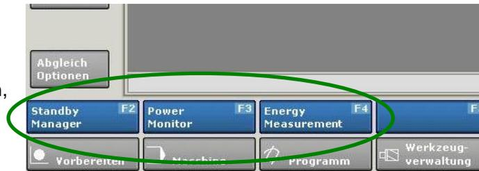
Abbildung II-6: Energiemanager mit den Funktionen Standby-Manager, Power-Monitor und Energy-Measurement
