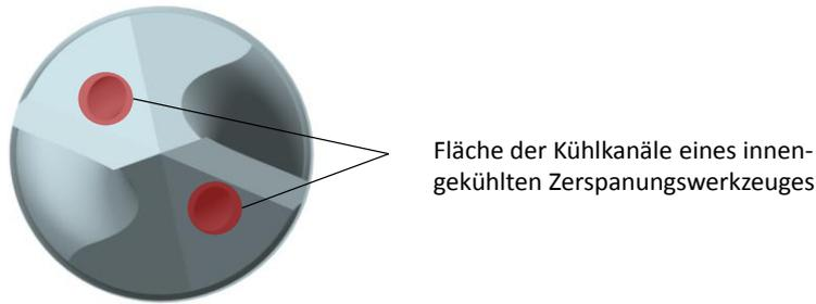
Abbildung II-36: Darstellung der inneren Kühlkanäle eines Zerspanungswerkzeuges
