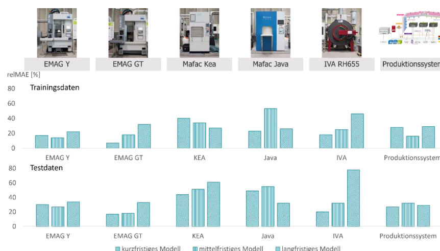
Abbildung 2.52: Relativer Mean Absolut Error für Trainings- und Testdaten der entwickelten Modelle.
