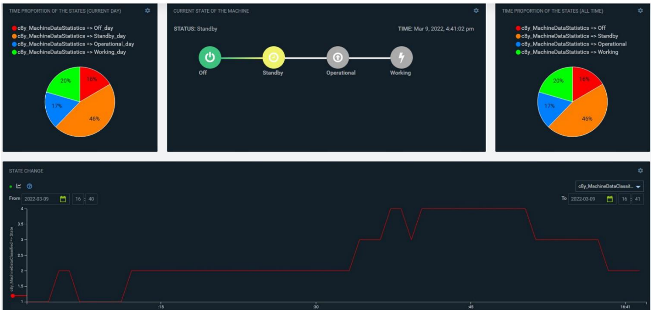
Abbildung 2.45: Cumulocity Dashboard zur Visualisierung der Maschinenzustände.
