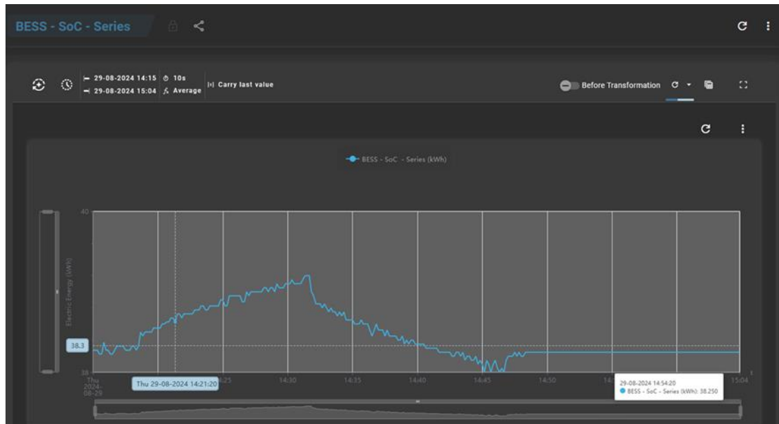
Abbildung 2.97: Einbindung des ETA-Batteriespeichers in die etalytics-Plattform sowie seitens ENTEGA gesteuerter Be- und Entladezyklus.
