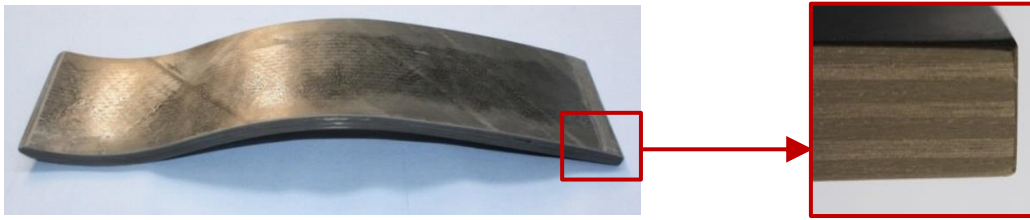
Abb. 4: Unteres geschwungenes Plattensegment des CFK-Schwenkarms: die Kontur der einzelnen Platten wurde vorgeformt, anschließend wurden die einzelnen, dünnen Platten miteinander verklebt, wie an der Schnittkante gut zu erkennen ist.
